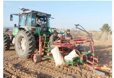
> Machine à marteau montée sur une enjambeuse, le guidage est assuré par un système Trimble, la commande du marteau et de l'arrosage est pilotée par une solution ACPI en utilisant le GPS Trimble (précision 2cm).
