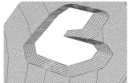
Puis on fait l'assemblage des 3 TN à l'aide de la nouvelle commande d'assemblage pour obtenir un TN complet :
