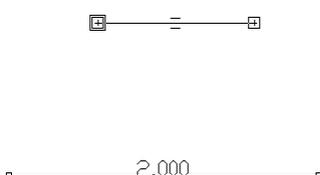
Les 2 points sont fixés sur une parallèle mais ne sont pas calculés, on doit encore fixer une distance ou une perpendiculaire (cette condition aurait pu être fixée avant)
